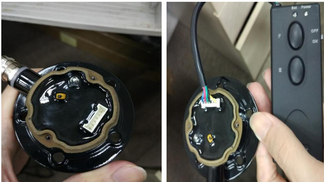
2. 满位校准：油箱加满油，将传感器放进油箱中，等待大约30s让传感器铝管中充满油；按住校准器F键待绿色LED闪烁后放开，表示传感器进入满位校准模式，大约10秒之后，闪烁的绿色LED熄灭表示满位数据校准OK；空位校准：将传感器完全移出油箱，待传感器中的油全部流出后，按住E键待绿色LED开始快速闪烁后放开，表示传感器进入空位校准模式，大约10s之后，闪烁的绿色LED熄灭表示空位校准OK。
