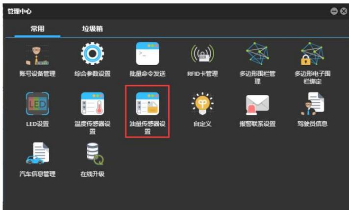
3. 出现油量传感器设置，单击添加按钮（如图红色框中），会弹出“添加油量传感器”的窗口，选择对应设备名称，油量传感器类型，高低油量报警百分比。点击“提交”设置就完成了。
