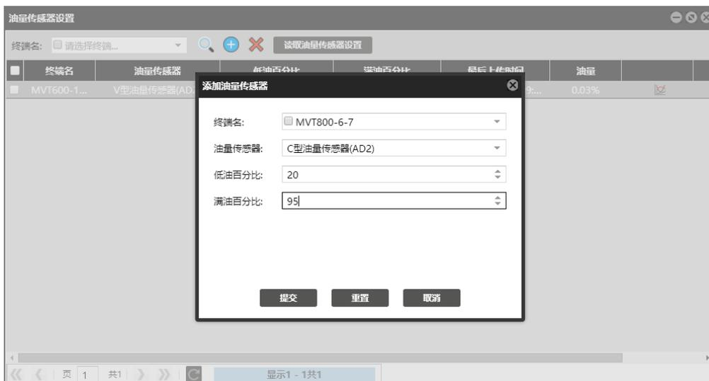
备注：上图中油量传感器有3种型号，其中C型代表电容输出油量传感器，R型代表电阻值输出油量传感器，V型代表电压值输出油量传感器，无则表示不使用油量传感器。（C型和R型是预留，以上两种油量传感器都是V型）
