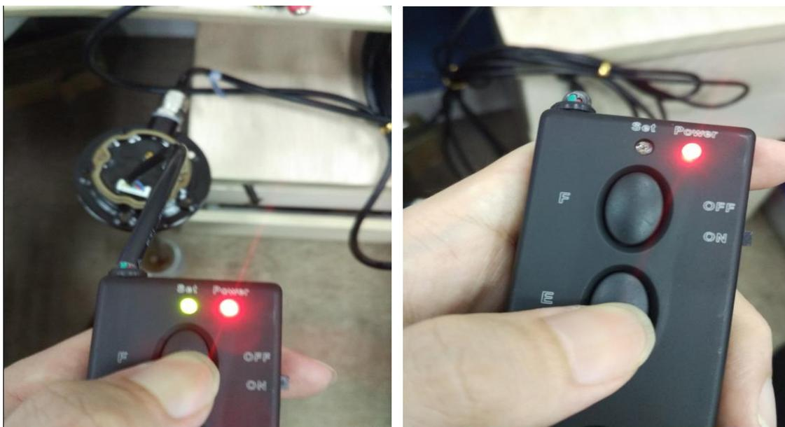
3. 校准结束，断开校准器：先将传感器红色线和黑色线连接电源，传感器正确接线完成后再进行通电，校准设置正式生效。校准OK后，将铝盖盖上，锁紧螺丝。
